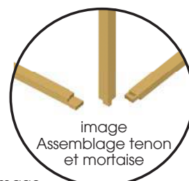
image Assemblage tenon et mortaise image construction avec châssis de fondation
