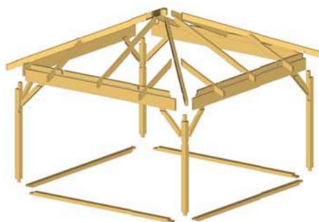
image Assemblage tenon et mortaise image construction avec châssis de fondation
